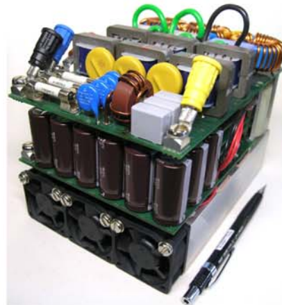
Fig. 16- Delta-switch rectifier prototype.
