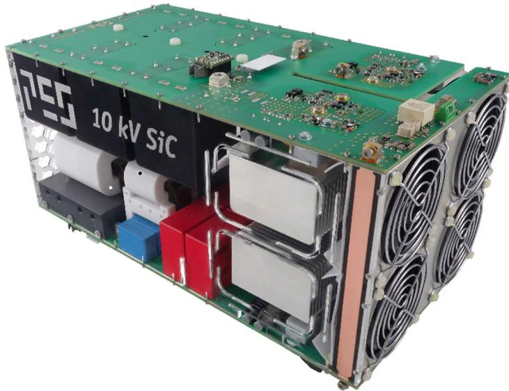
Ein an der ETH Zürich entwickelter leistungselektronischer Solid-State-Transformator gibt mit seinem kompakten und effizienten Aufbau einen Vorgeschmack auf die Zukunft der elektrischen Energieversorgung.
