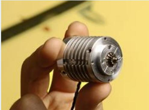
Gerade einmal 22 mal 60 Millimeter misst der Kompressor. ([Grossbild](#)).
