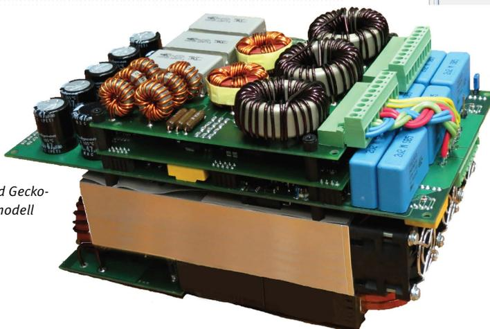
Bild 1: Realisierung und Gecko-CIRCUITS-Simulationsmodell eines SWISS-Rectifiers
