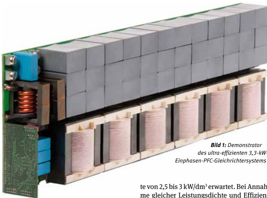
**Bild 1:** Demonstrator des ultra-effizienten 3,3-kW-Einphasen-PFC-Gleichrichtersystems
